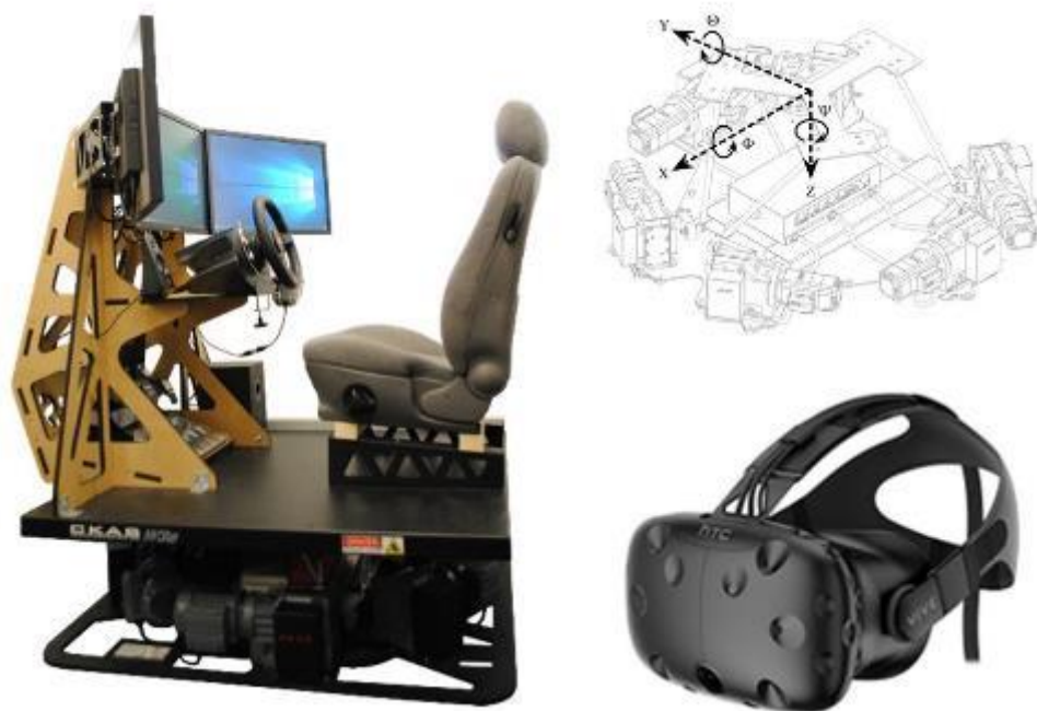
Abb. 4 Bewegungsplattform des Fahrsimulators (links), Freiheitsgrade der Bewegungsplattform im Fahrsimulator (rechts oben), HMD (rechts unten)
