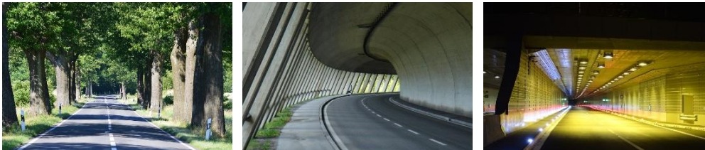
Abb.1 Flickereffekte durch natürliches Licht auf Baumalleen (links) und in Galerien (Mitte) sowie durch künstliche Beleuchtung in Strassentunneln (rechts)
